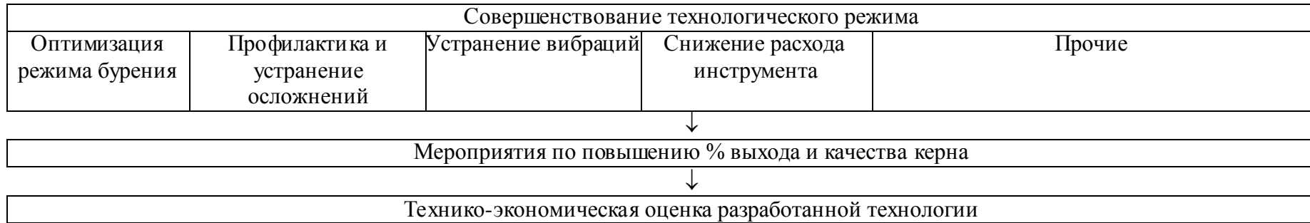
Рис. 2.1. Схема разработки технологии бурения геологоразведочных скважин на твердые полезные ископаемые
